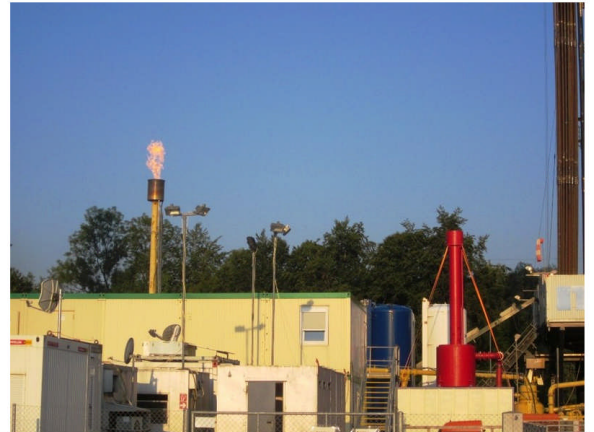
Die Arbeiten am Tag danach. Das Gas im Bohrloch wurde kontrolliert abgefackelt, ... Bild: Stadt St. Gallen
